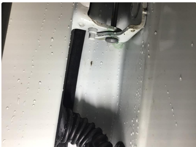
1.1 Antydning til korrosjon i begge dører høyre side og venstre bakdør, dette av ubetydelig karakter
