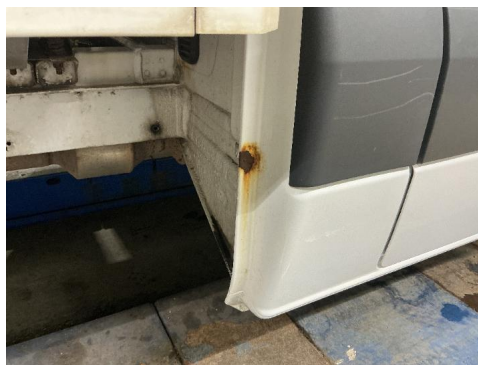
29. Høyre utvendig synlig B-stolpe
