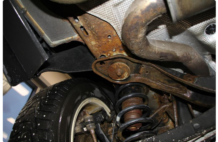
2.2 En hel del rust i chassis, også en del i hjulhus foran.
