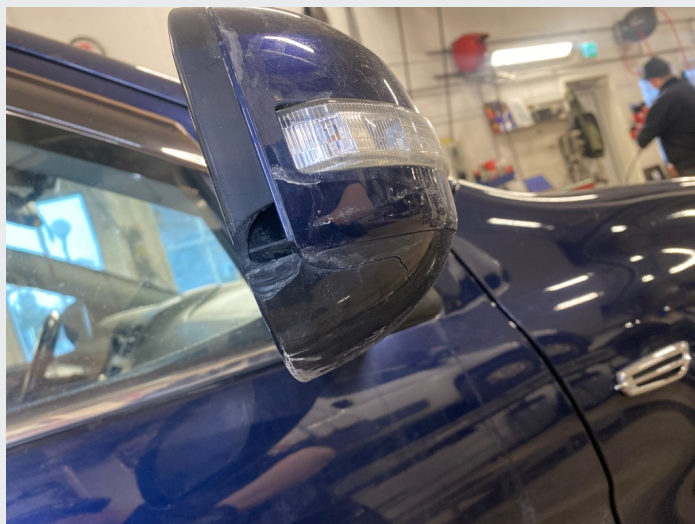
2.12 Skade høyre speil
