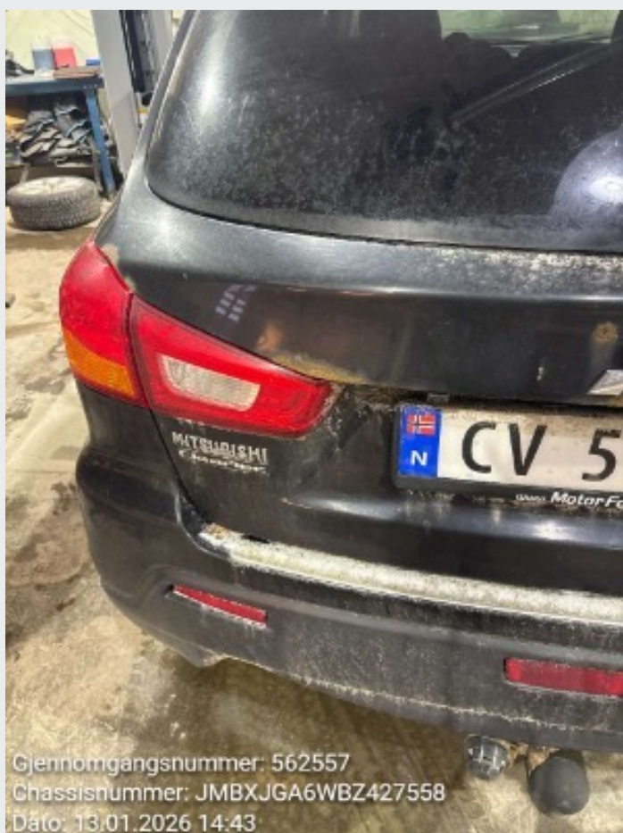
2.5 Rust på bakluke
