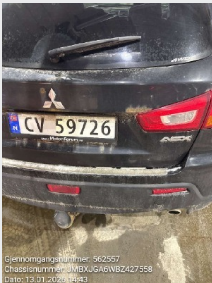
2.5 Rust på bakluke
