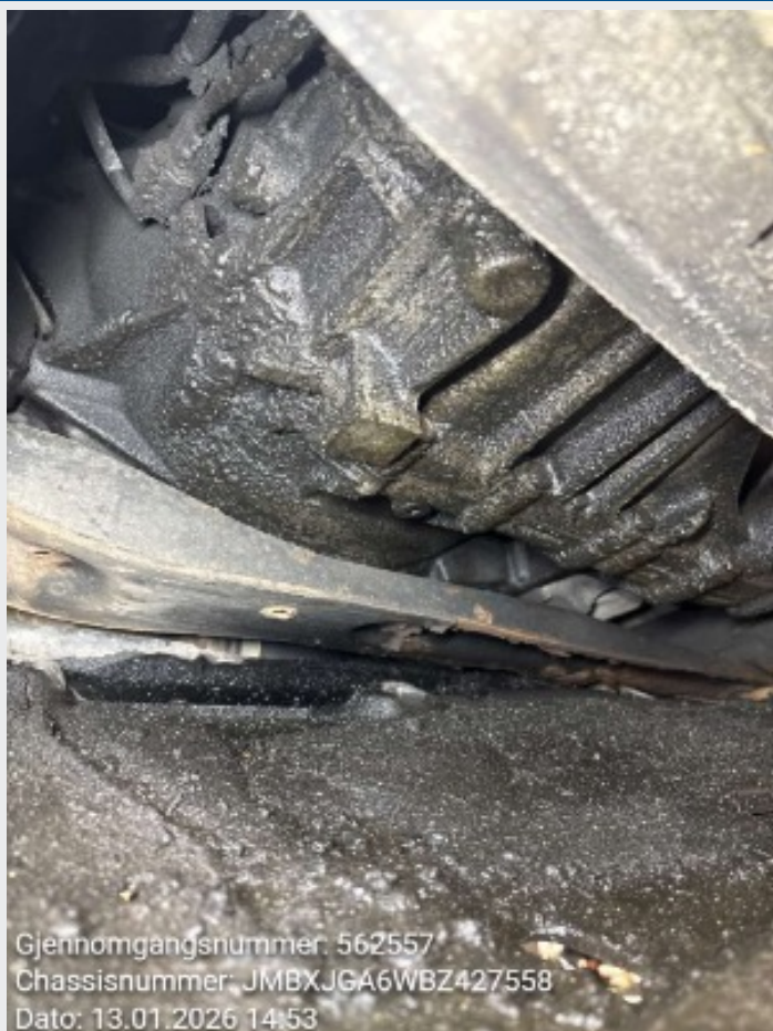
6.3 Lekkasje motor/gir. Vanskelig og se da det er litt søl.
