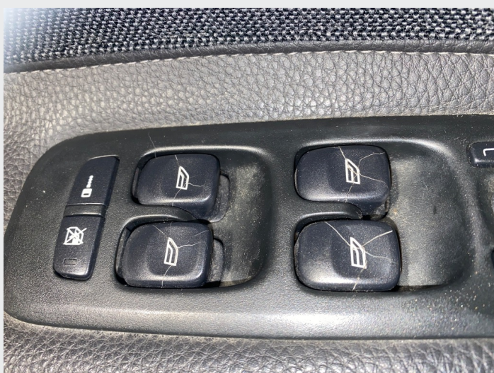
4.2 Sprukket knapper til vindusheis, førerdør
