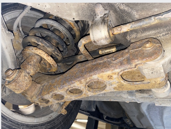
2.2 Rust under bil
