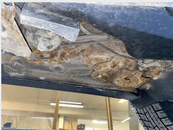
2.2 Rust under bil
