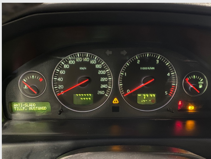
4.2 Umulig å lese tripteller da hele elektronikken har feil
