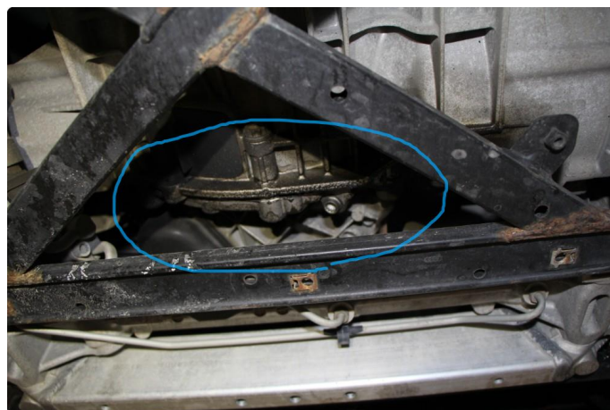
3.4 Oljelekkasje mellom motor/gear
