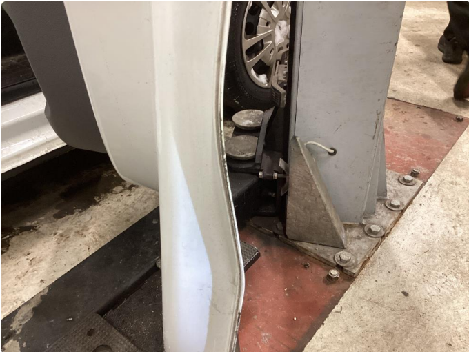
1.3 Ripe ned til grunning
