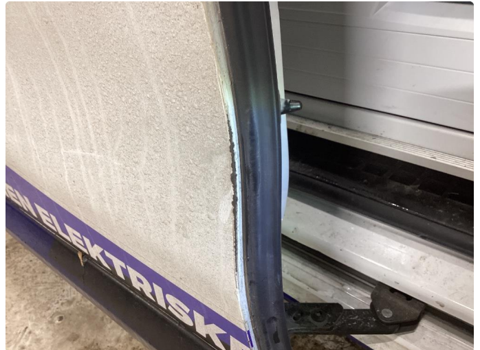
1.3 Ripe ned til grunning
