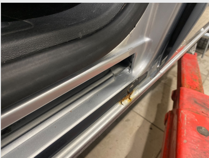
2.4 Rust høyre side i dør
