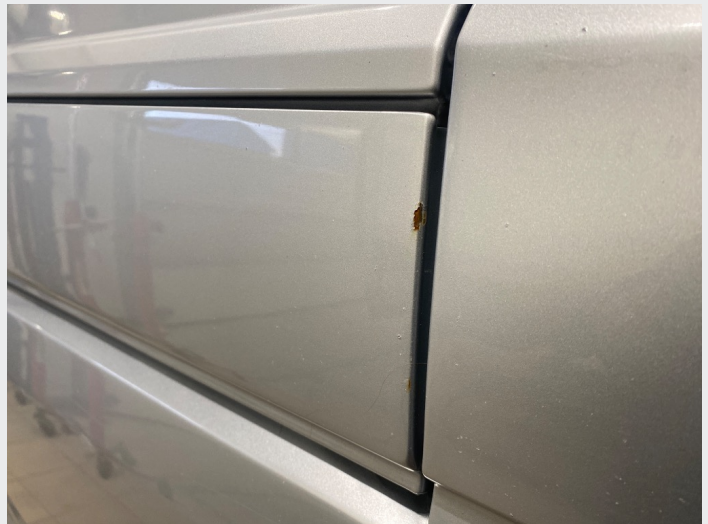
2.7 Påbegynt rust høyre bak
