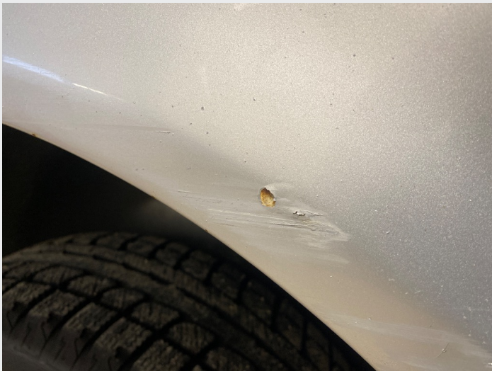
2.7 Påbegynt rust høyre bak
