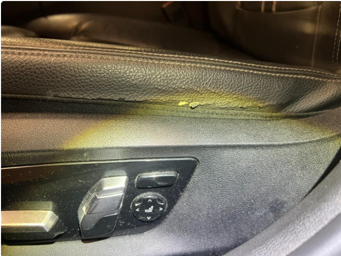
2.1 Setetrekk fører har en sprekk/rift.
