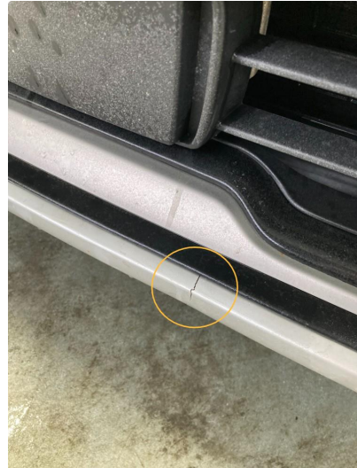
1.3 Liten sprekk nederst på støtfanger foran (plast)
