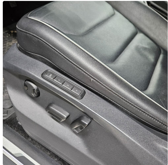
2.1 Lite sår/hakk i setetrekk, sidevange
