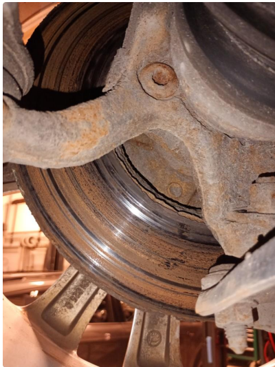
2.1 Mer enn 25% rust, blir byttet 14/1
