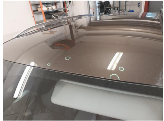
1.6 Steinsprut med rust
