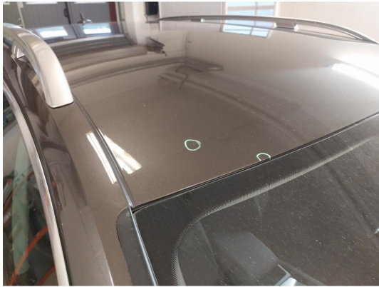
1.6 Steinsprut med rust
