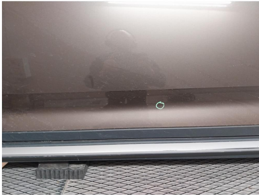
1.1 Steinsprut med rust
