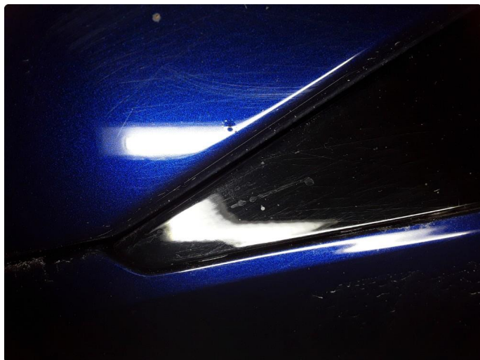
1.3 Liten steinsprut med korrosjon.
