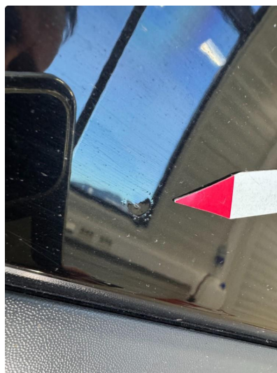
1.2 Liten steinsprut med korrosjon.
