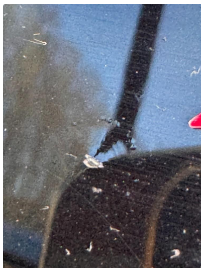
1.2 Liten steinsprut med korrosjon.
