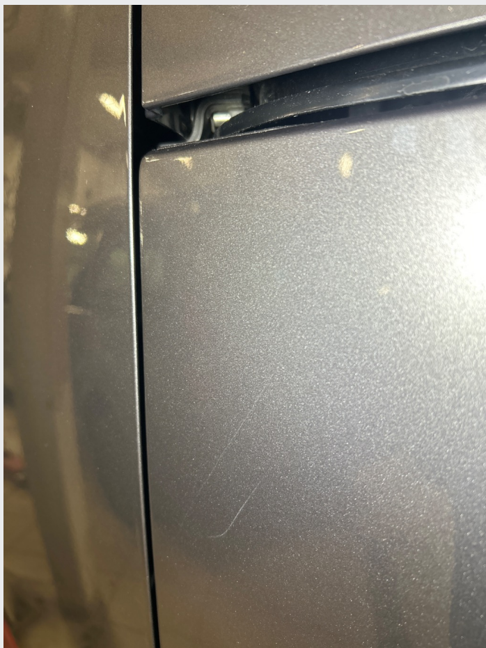
2.1 Noe steinsprut, riper og småbulker rundt om
