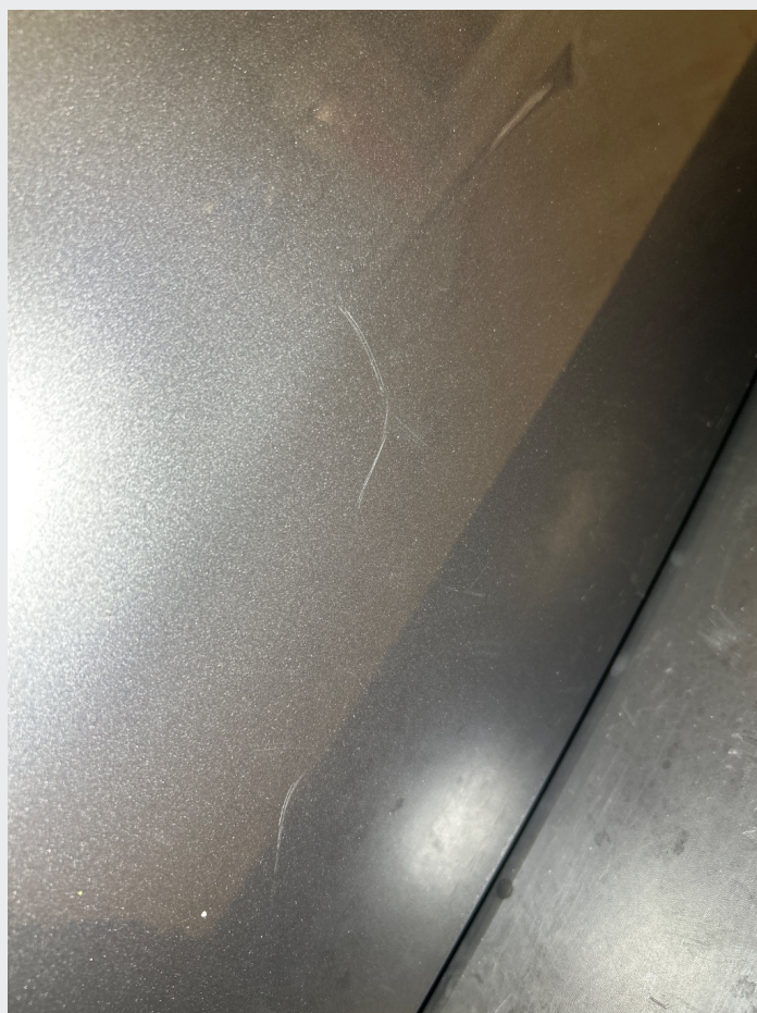
2.1 Noe steinsprut, riper og småbulker rundt om
