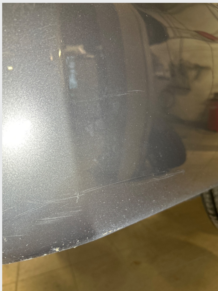
2.1 Noe steinsprut, riper og småbulker rundt om
