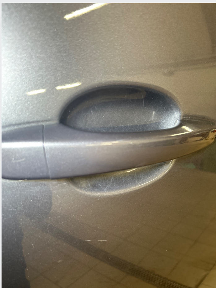
2.1 Noe steinsprut, riper og småbulker rundt om
