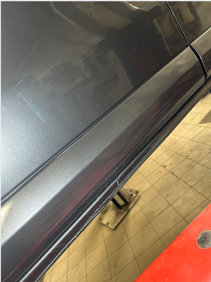
2.1 Noe steinsprut, riper og småbulker rundt om
