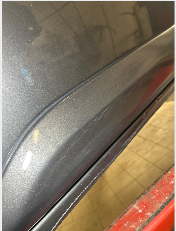
2.1 Noe steinsprut, riper og småbulker rundt om
