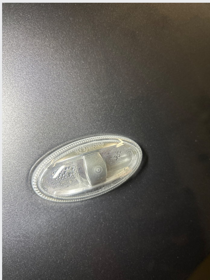
3.4 Litt fukt i blinklykt i høyre framskjerm
