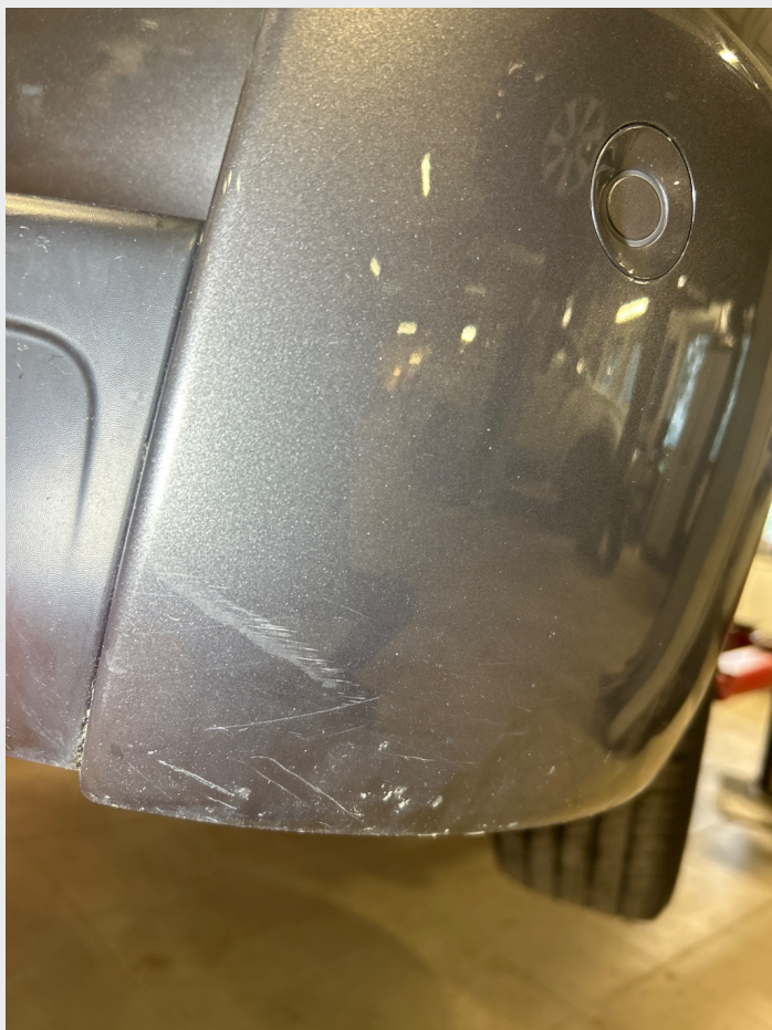
2.1 Noe steinsprut, riper og småbulker rundt om
