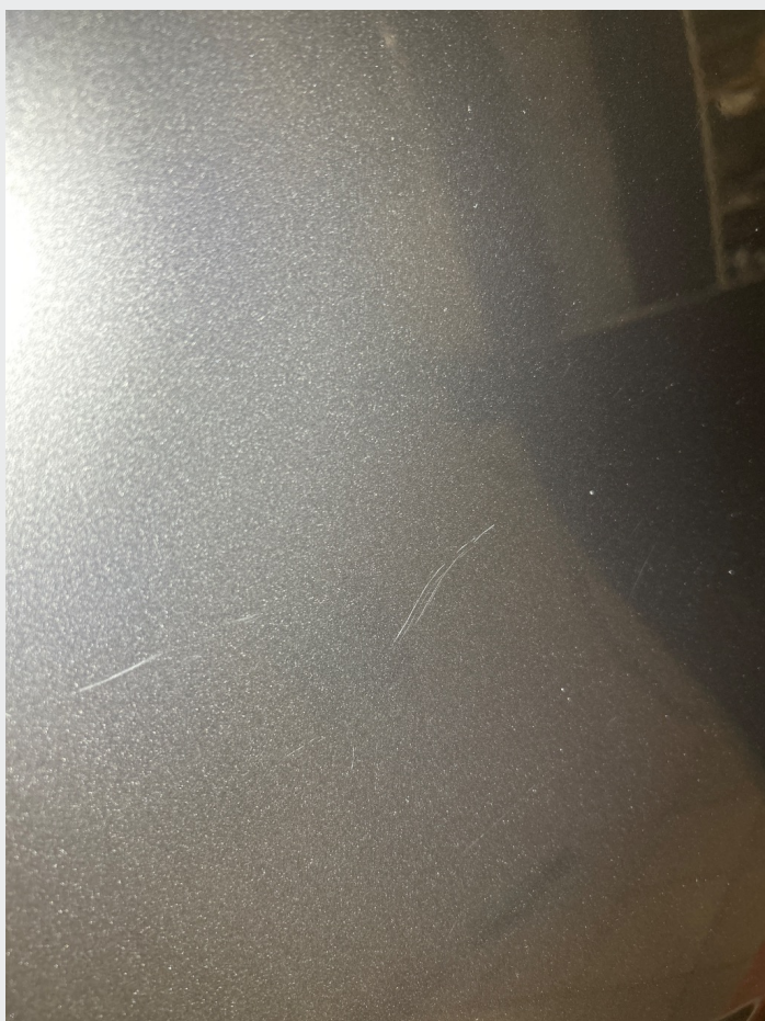
2.1 Noe steinsprut, riper og småbulker rundt om
