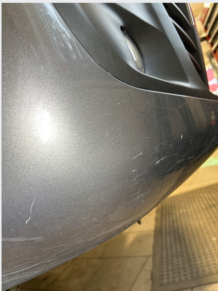
2.1 Noe steinsprut, riper og småbulker rundt om
