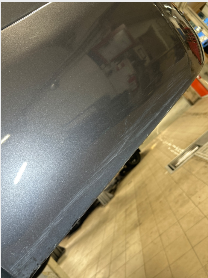
2.1 Noe steinsprut, riper og småbulker rundt om
