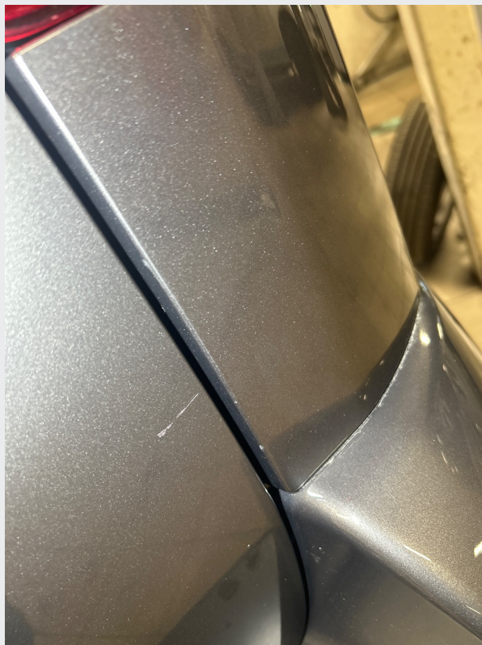
2.1 Noe steinsprut, riper og småbulker rundt om
