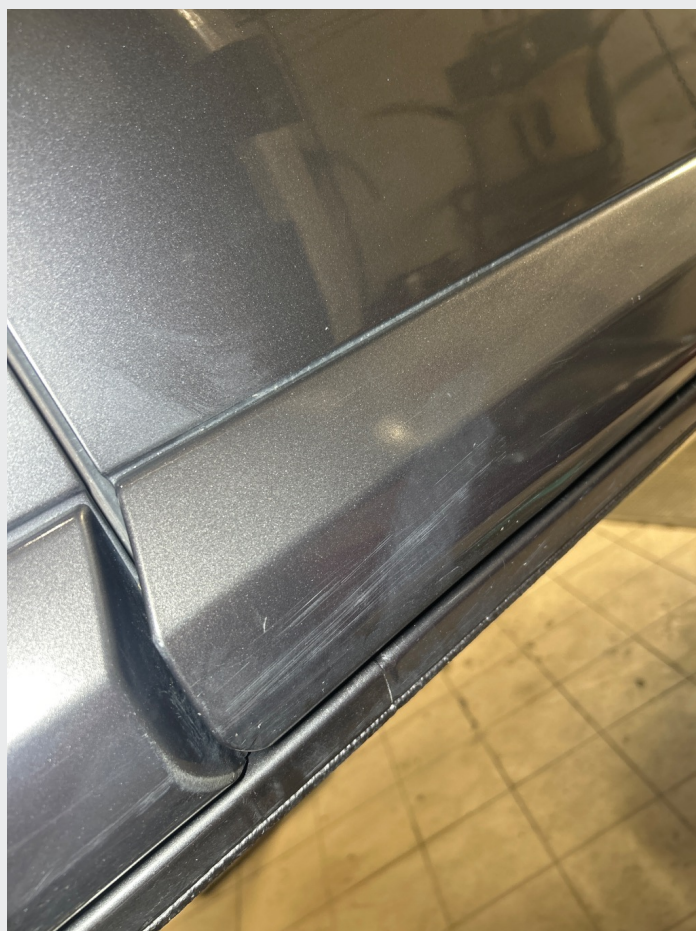
2.1 Noe steinsprut, riper og småbulker rundt om
