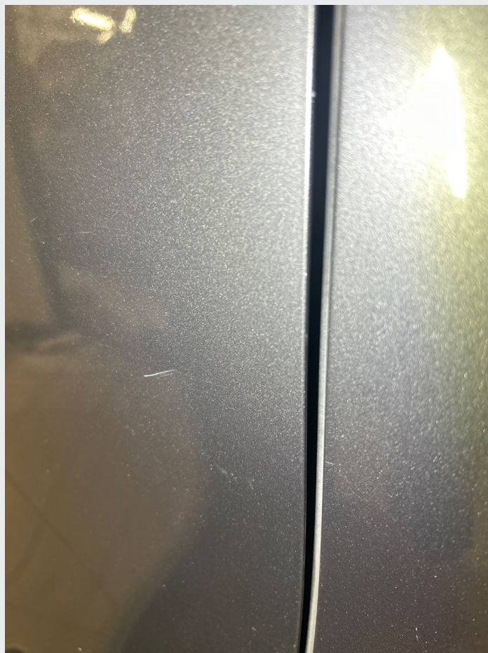
2.1 Noe steinsprut, riper og småbulker rundt om
