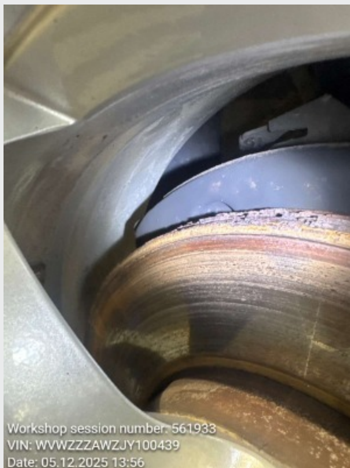
9.7 Bremseskiver foran er det litt overflate rust. Normalt. Godkjent på EU-kontroll.
