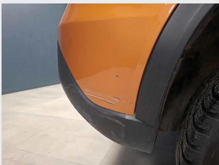
2.1 Skade/Riper/Merke støtfanger h.s.b
