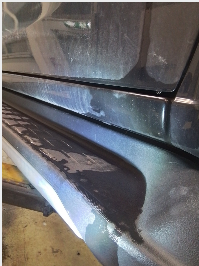
2.4 Bulk I kanal Høyre
