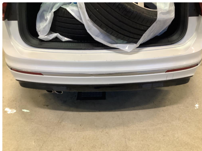
1.2 Ripe(r) ned til grunning
