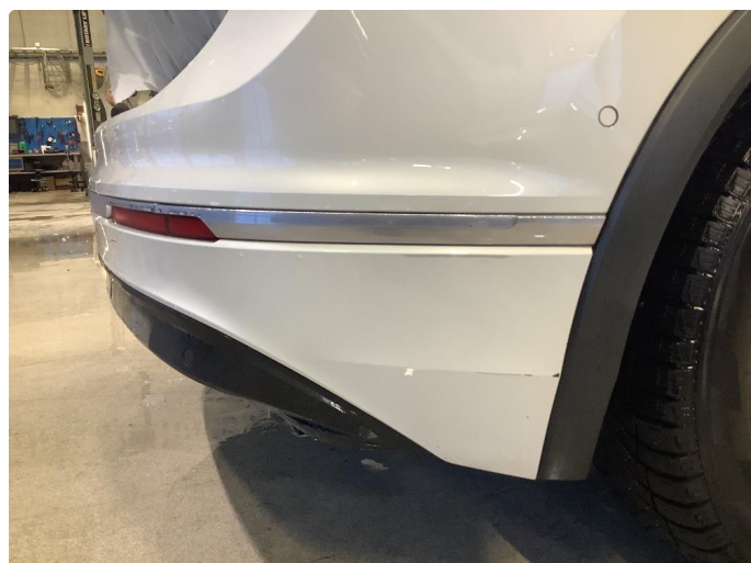
1.2 Ripe(r) ned til grunning
