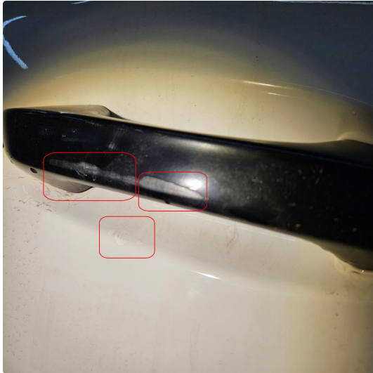
1.1 Riper på håndtak skyvedør + små lakkskader på skyvedør ved/bak håndtak - blitt penslet m/lakk
