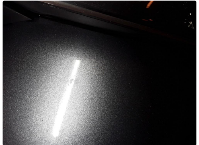
1.2 Liten steinsprut med korrosjon.
