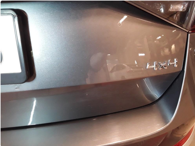
1.2 Liten steinsprut med korrosjon.
