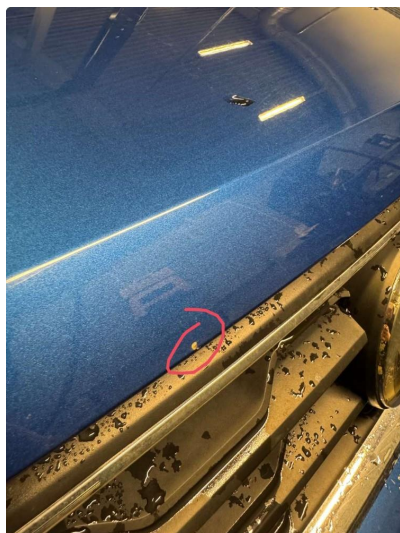
1.1 Noe steinsprut med rust
