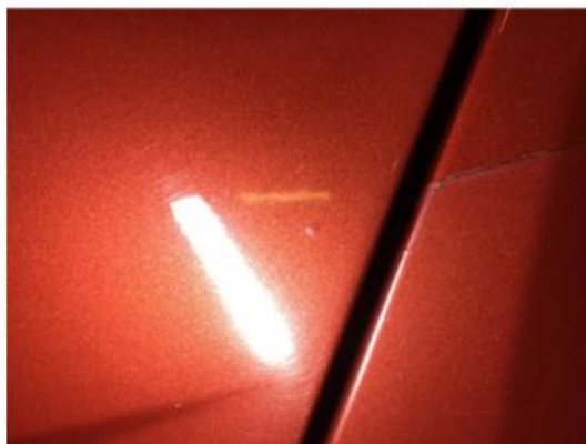
1.1 Boble i lakk skjerm HF, skjerm VF, dør HF, dør VF, dør VB og bakluke
