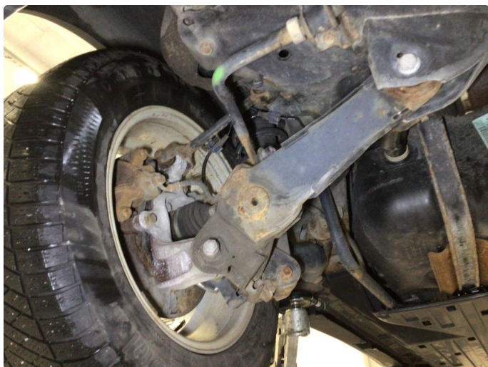
2.2 Noe overflaterust i bakstilling, ingen tiltak kreves
