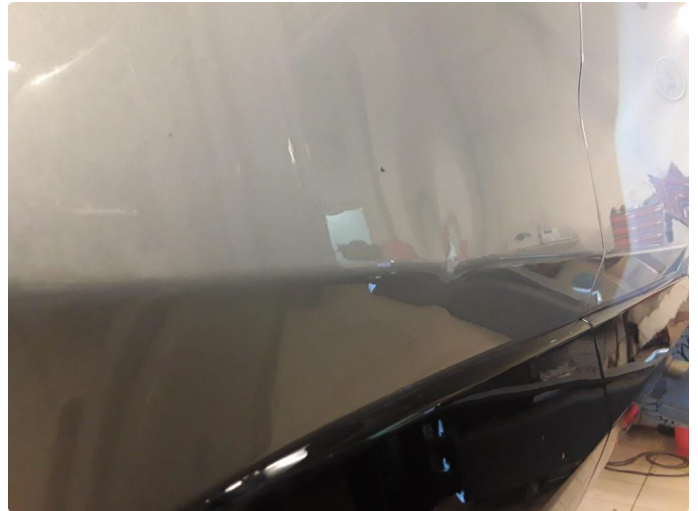
1.2 Liten bulk høyre bakdør. Blir forsøkt med bulkfix.
