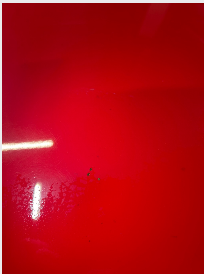
2.1 En del steinsprut og riper rundt om
