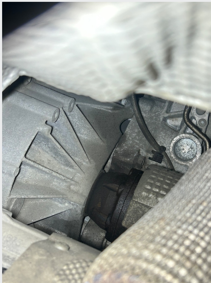
7.1 Svetting simmering girkasse - drivaksel begge sider
