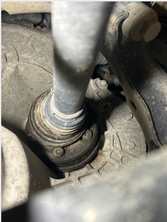
7.1 Svetting simmering girkasse - drivaksel begge sider
