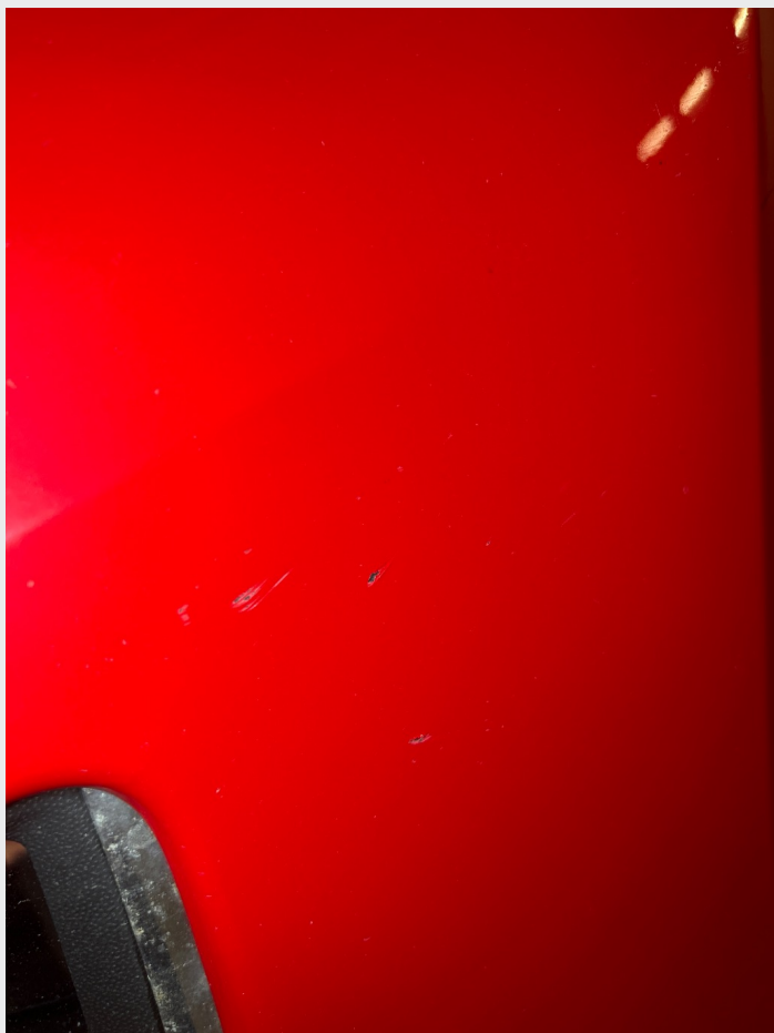
2.1 En del steinsprut og riper rundt om
