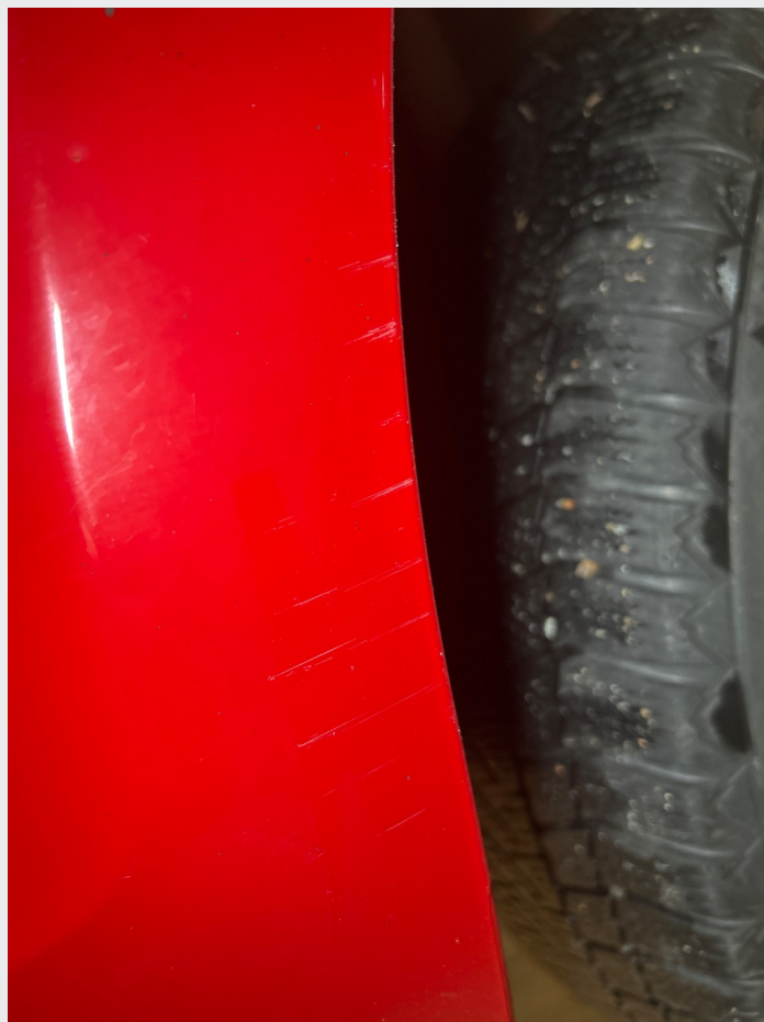
2.1 En del steinsprut og riper rundt om
