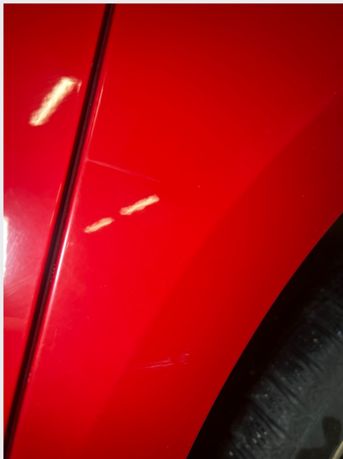
2.1 En del steinsprut og riper rundt om
