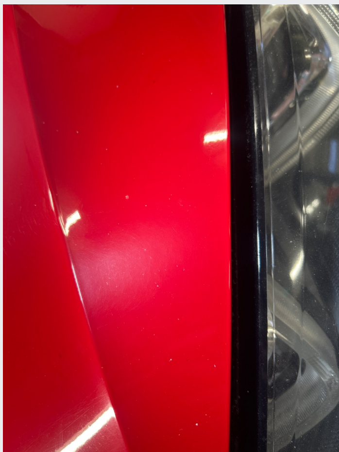
2.1 En del steinsprut og riper rundt om
