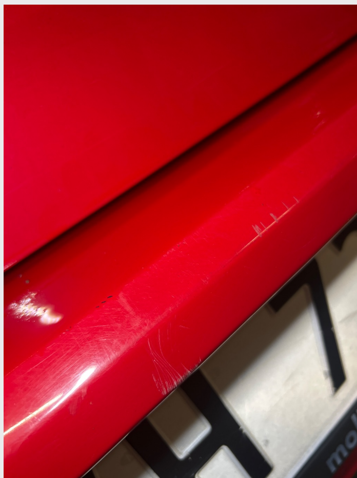
2.1 En del steinsprut og riper rundt om
