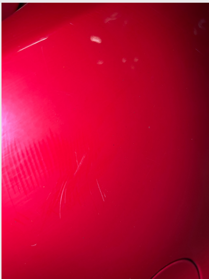
2.1 En del steinsprut og riper rundt om
