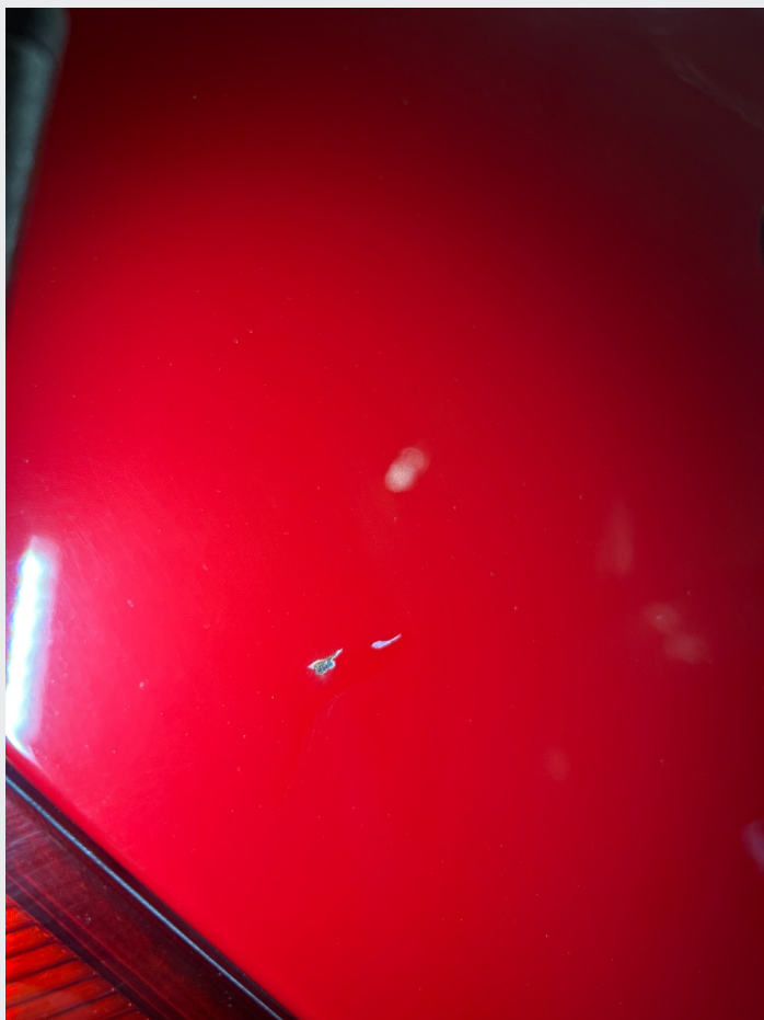
2.1 En del steinsprut og riper rundt om
