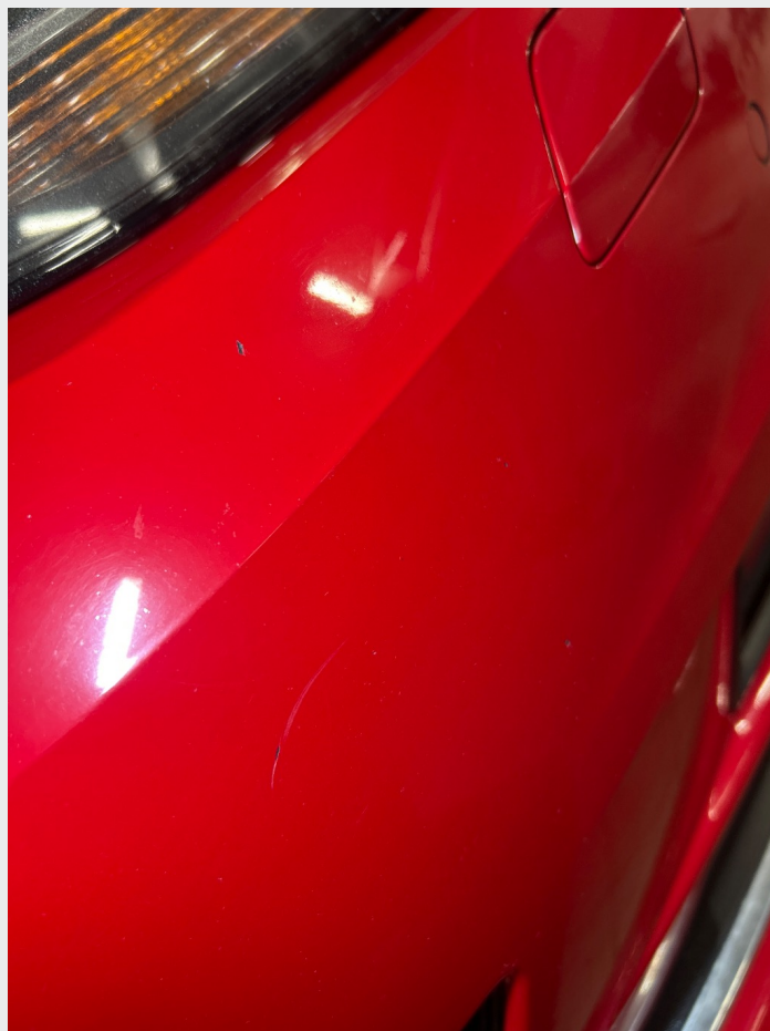
2.1 En del steinsprut og riper rundt om
