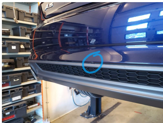
1.6 Ripe(r) ned til grunning
