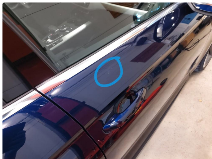
1.1 Ripe ned til grunning
