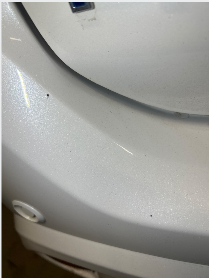
2.1 En del riper og steinsprut rundt om
