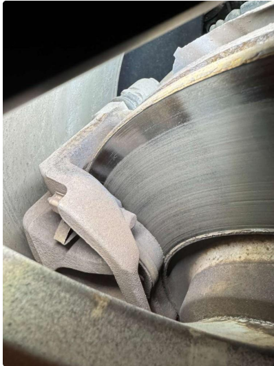
2.1 Rust, blir byttet før salg
