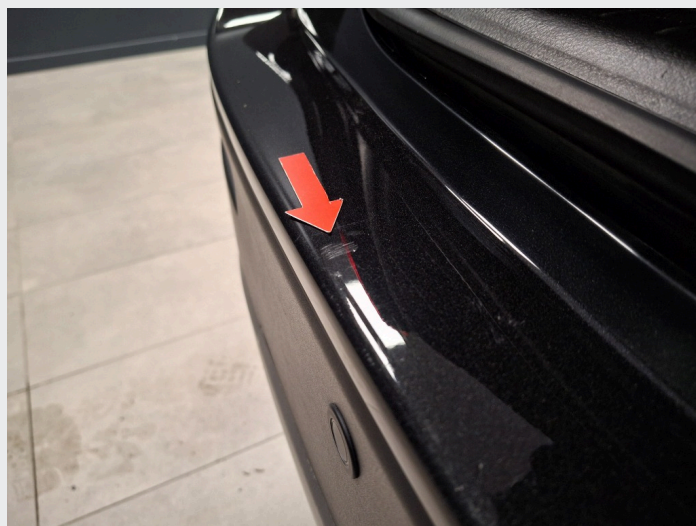
2.8 Merke/riper på støtfanger bak
