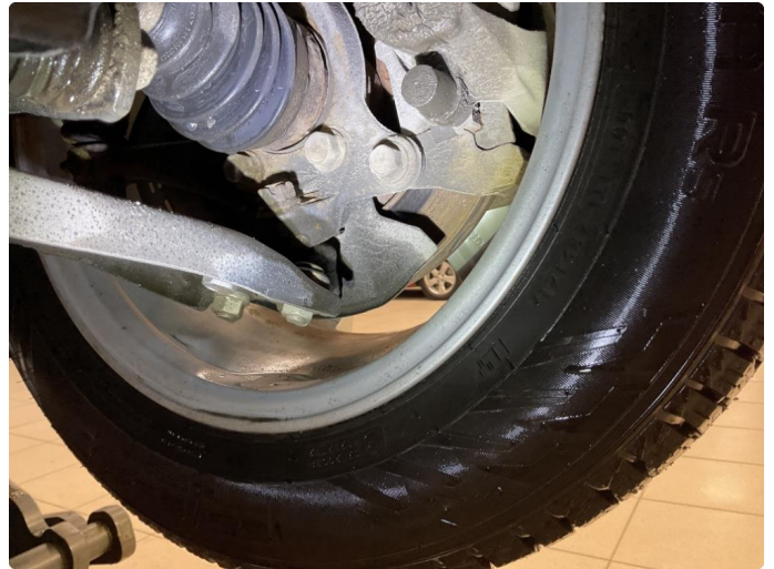
1.1 Noe over flate rust på skiver
