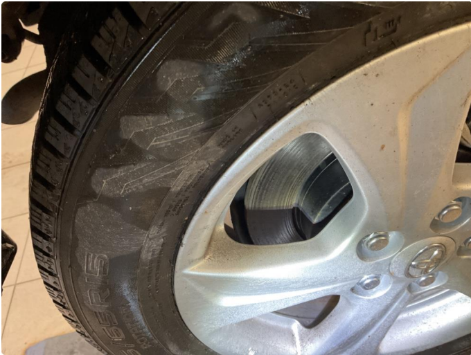
1.1 Noe over flate rust på skiver
