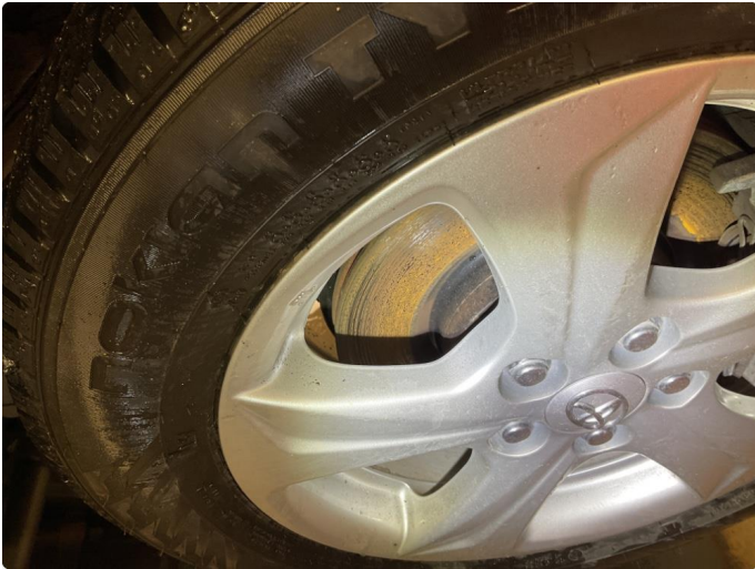
1.1 Noe over flate rust på skiver
