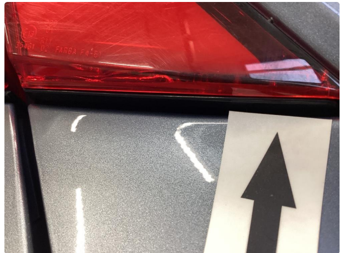
1.1 Krakelering i plast. MINDRE KOSMETISK ANMERKNING. MER NORMAL ENN UNORMAL.
