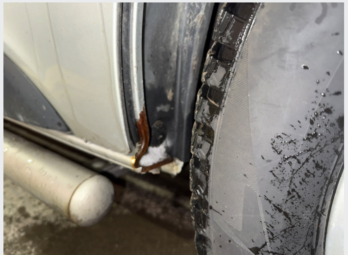
2.7 Litt rust på hjulbuene
