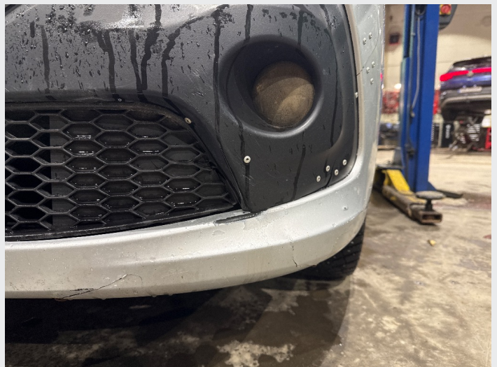
2.8 sprek i støtfanger og noen striper
