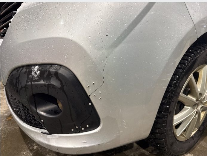
2.8 sprek i støtfanger og noen striper
