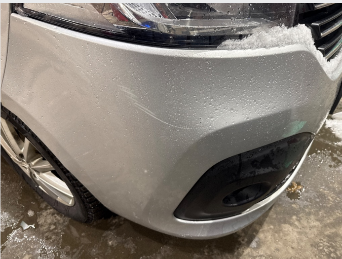
2.8 sprek i støtfanger og noen striper
