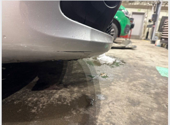
2.8 sprek i støtfanger og noen striper
