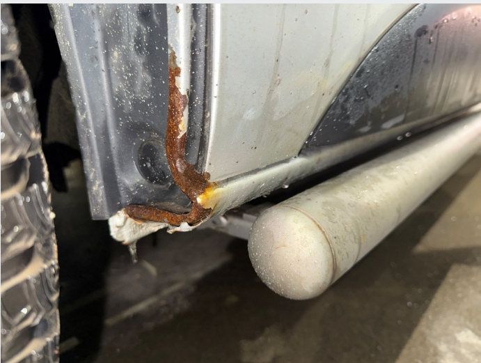
2.7 Litt rust på hjulbuene
