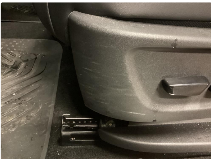
2.1 Små riper i plast deksel ved sete
