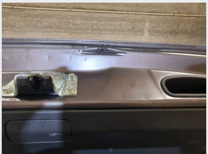
2.5 Skade på innside bakluke ved lås
