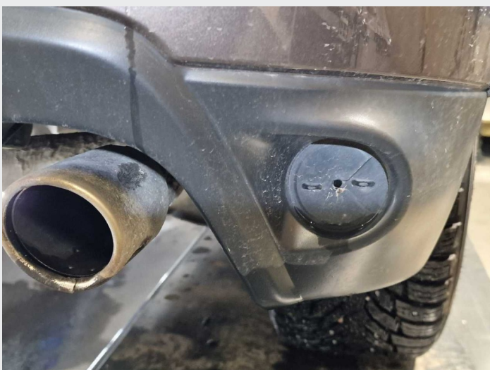
2.8 Mangler refleks på støtfanger bak
