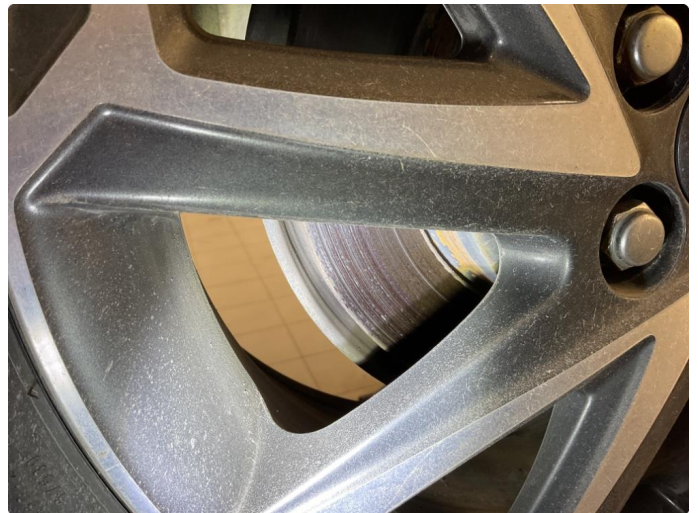
1.1 Noe over flate rust på skiver
