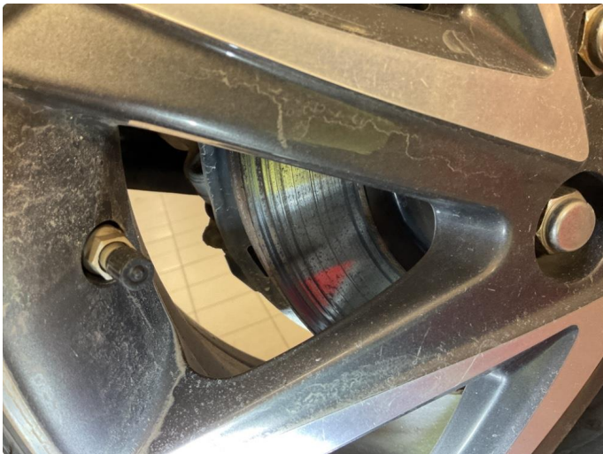
1.1 Noe over flate rust på skiver
