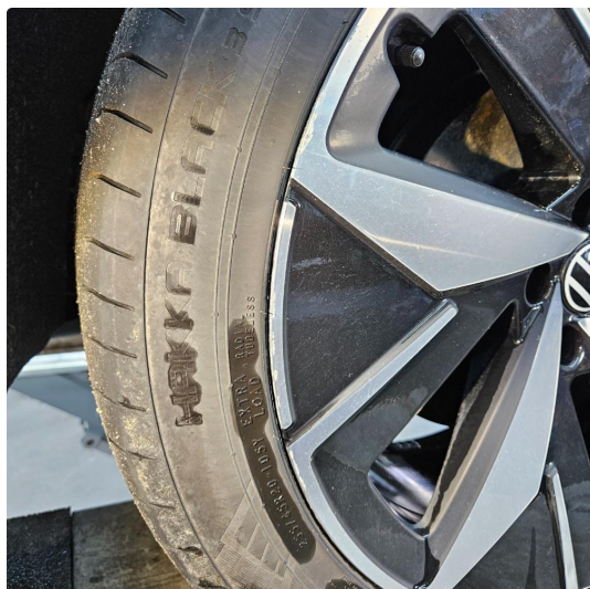
1.1 Skrubbermerker, ytre kant, på 3 av 4 sommerfelger
