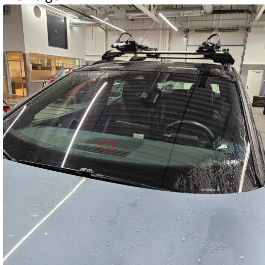
1.4 Div steinsprut, steinsprut m/sprekk limes/repareres før levering
