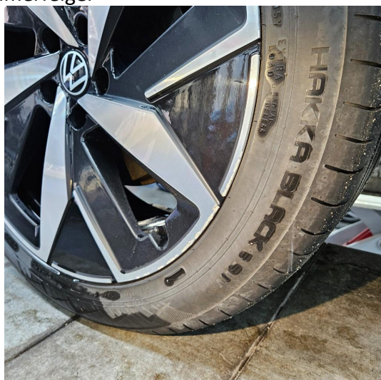
1.1 Skrubbermerker, ytre kant, på 3 av 4 sommerfelger
