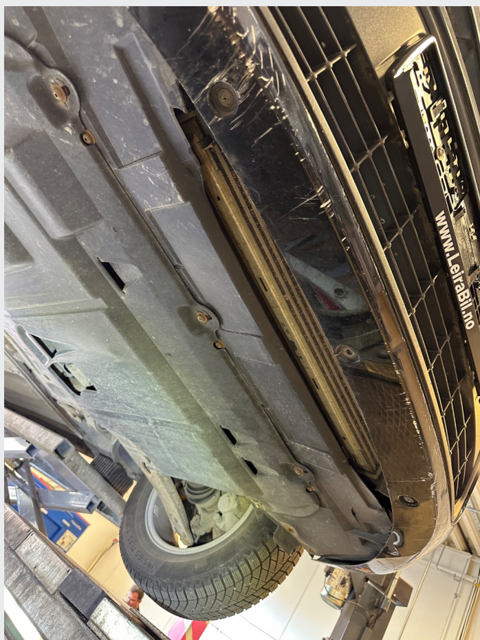
2.2 Bunnplate under radiator knekt
