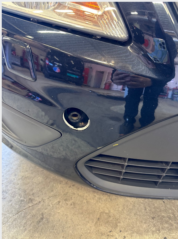
2.8 Deksel til feste av slepekrok mangler
