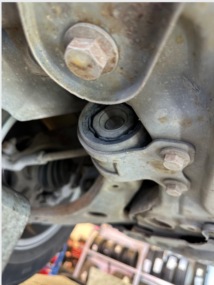
8.5 Bakre nedre bærebryforinger ba foran holder på å slippe
