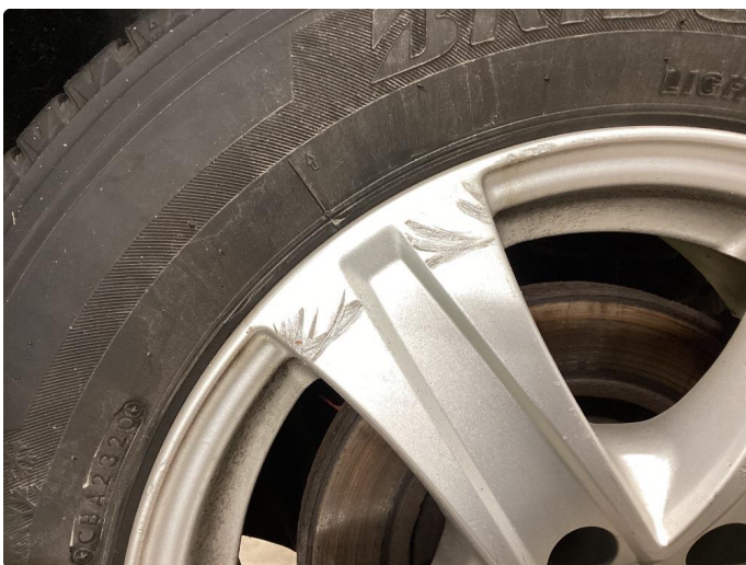
1.1 Skade på felg
