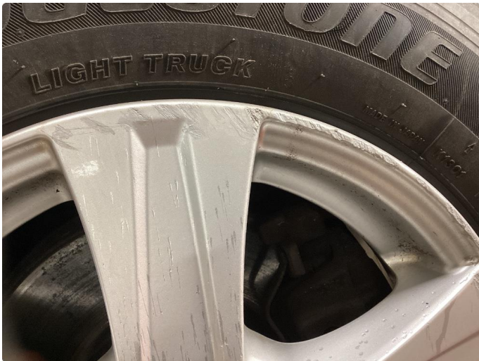
1.1 Skade på felg
