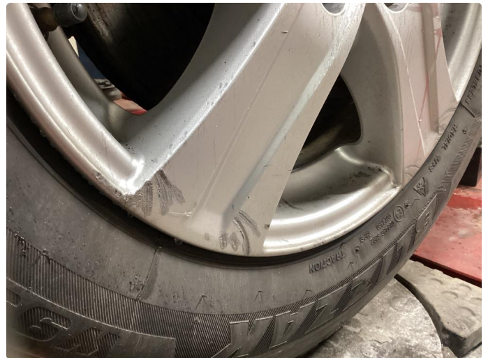
1.1 Skade på felg
