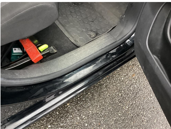
1.4 Bulk(er) med lakkskade
