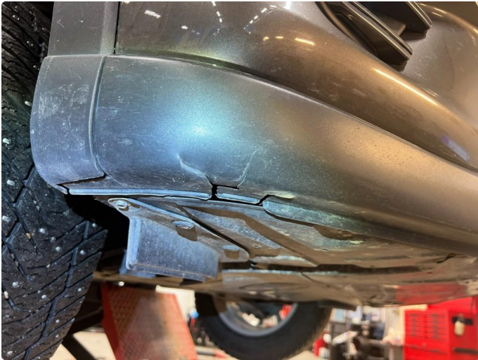
1.1 Skade i plastikk foran
