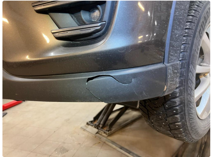
1.1 Skade i plastikk foran
