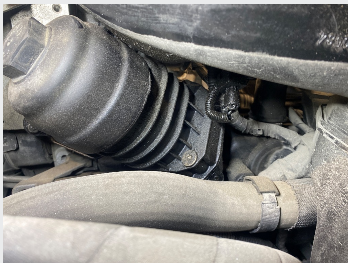
5.10 Oljesvetting rundt oljefilterkopp, ikke unormalt for merke
