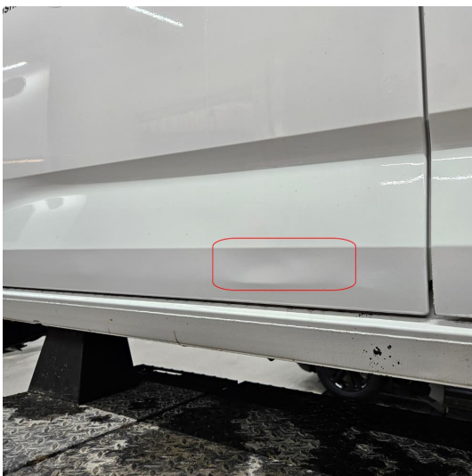
1.3 Bulk nede på skyvedør, h.side
