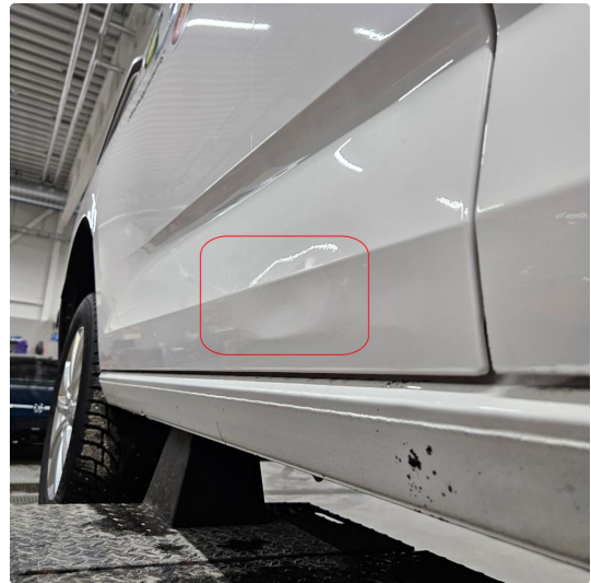
1.3 Bulk nede på skyvedør, h.side
