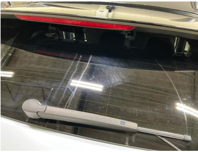
1.4 Mekanisk slitasje bakvindu
