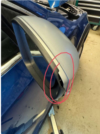
1.2 Deksel skadet/ripe, blir byttet 14/11
