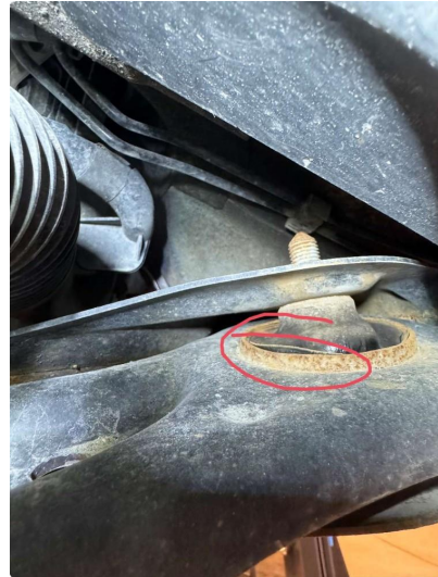
2.1 Slitt bærefororing, blir utbedret 14/11
