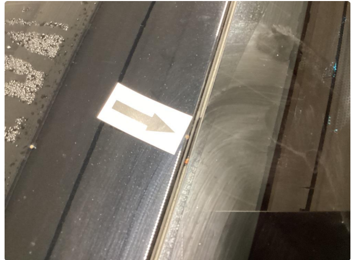
1.1 Steinsprut med rust. UTBEDRET MED LAKKSTIFT SIDEN DETTER ER EN MINDRE TYPE STEINSPRUT.
