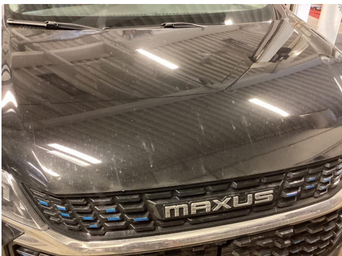
1.2 En del steinsprut på panser
