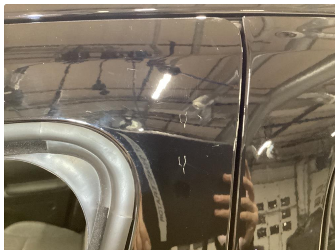
1.2 Ripe ned til grunning
